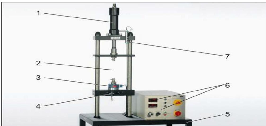
1 cylindre hydraulique à double effet, 2 zone de travail, 3 capteur de force, 4 traverse inférieure réglable en hauteur avec verrouillage, 5 bâti, 6 éléments d'affichage et de commande, 7 capteur de déplacement
