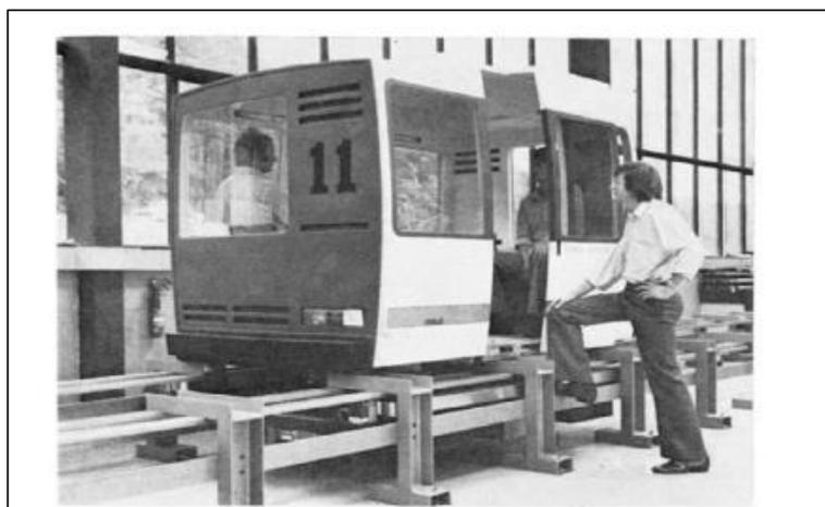
**Figure I. 2** : Véhicule a suspension électromagnétique, réalisé à l'université Sussex
