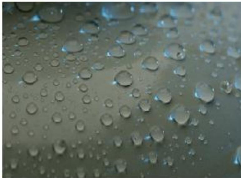
**Fig. II.6 :** hydrophobicité d'une surface en silicone [24]
