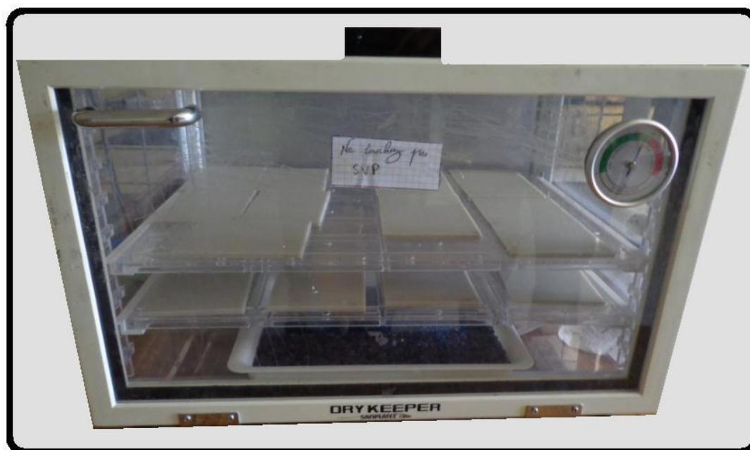
Fig. IV. 6: Photo montrant un dessiccateur
