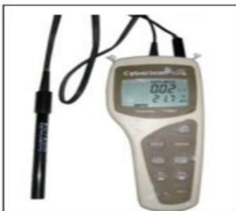
**Fig. IV. 5:** Appareil de mesure de conductivité volumique
