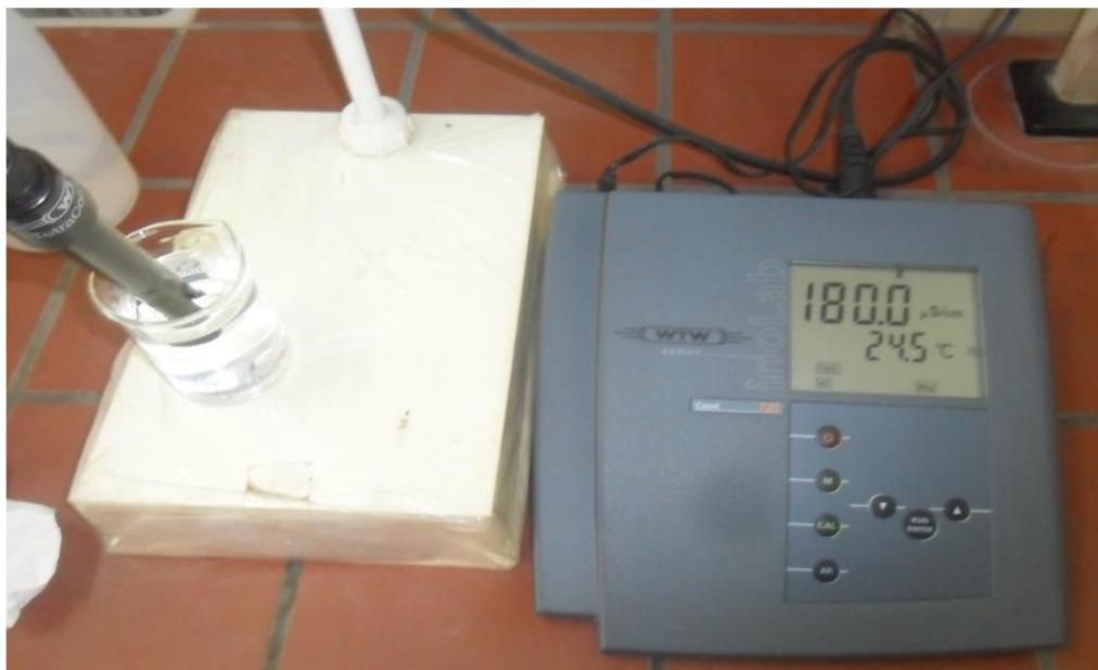
**Fig. IV.4 :** Conductimètre (appareil de mesure de conductivité volumique)
