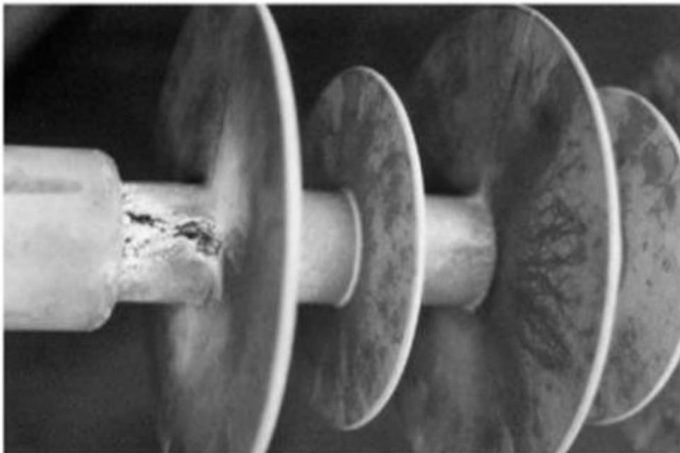
Fig. I.21: Etat de l'isolateur après une longue durée de son vieillissement
