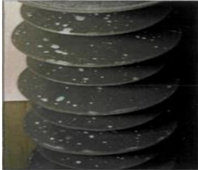
**Fig. I.1:** Isolateur composite en silicone trempé dans le sel (NaCl) et de kaolin
