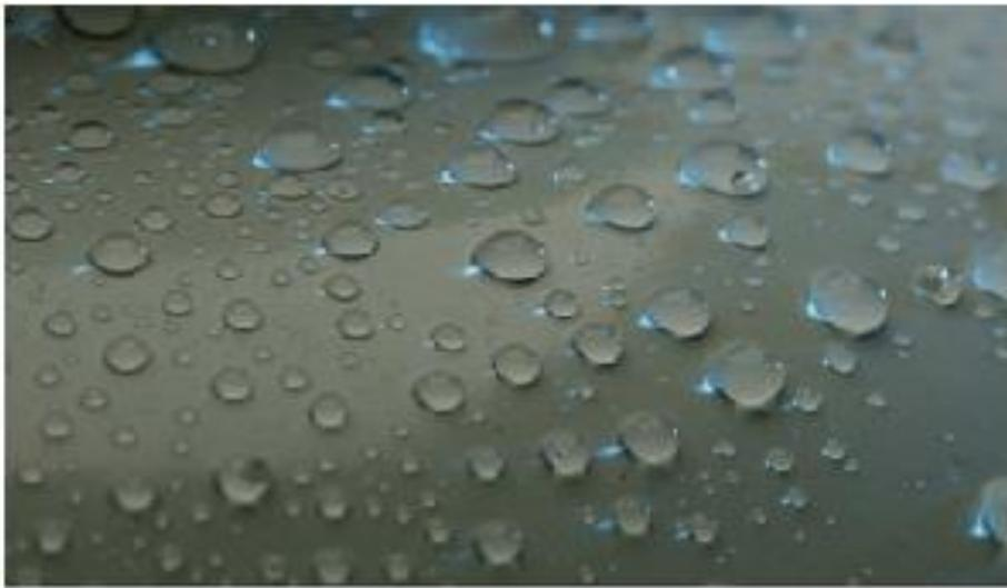
**Fig. II.8 :** Hydrophobicité d'une surface en silicone
