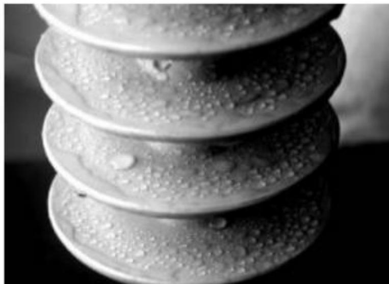
**Fig. I.19:** Image de l'isolant 6s10 au 6<sup>ème</sup> jour de son vieillissement
