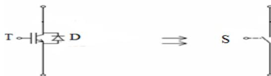
Figure I.2. Interrupteur bidirectionnel.
