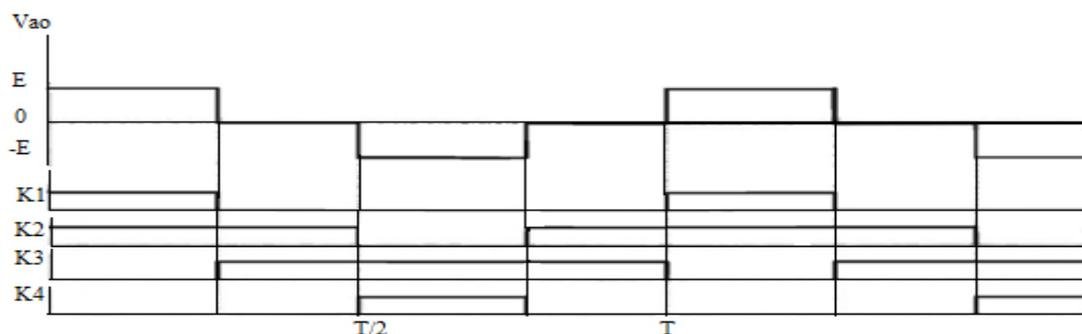
**Figure II.7.** Formes d'ondes d'un bras d'onduleur en cascade à trois niveaux.
