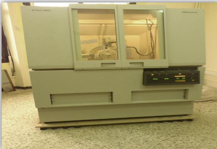
**Fig.17.** L'appareille de la diffraction des rayons X.
