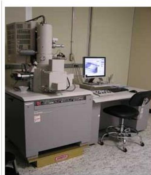
FIGURE 2.1 – Microscope électronique à balayage *MEB* de la marque *JSM* – 6360.
