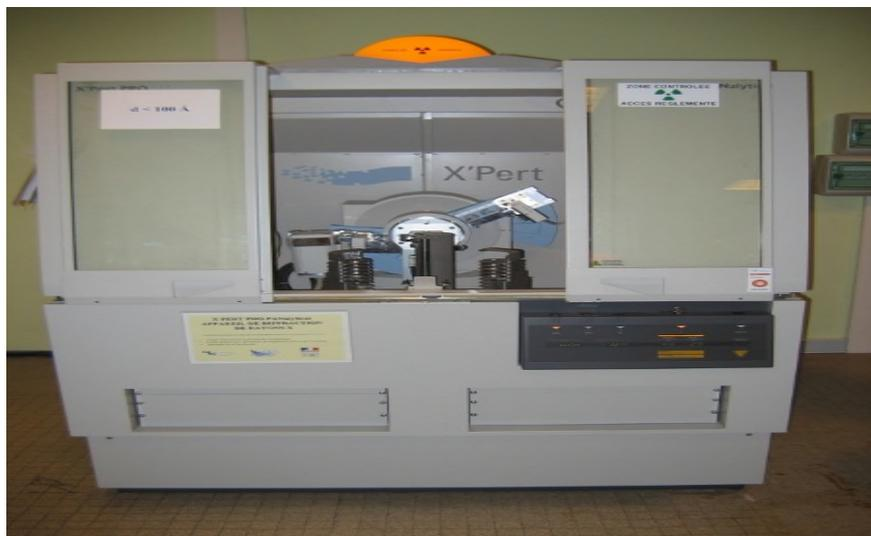
*Figure II-6: Diffractomètre des rayons X*
