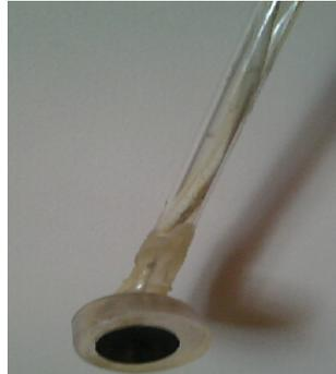
*Figure II-2: l'électrode du carbone vitreux*
