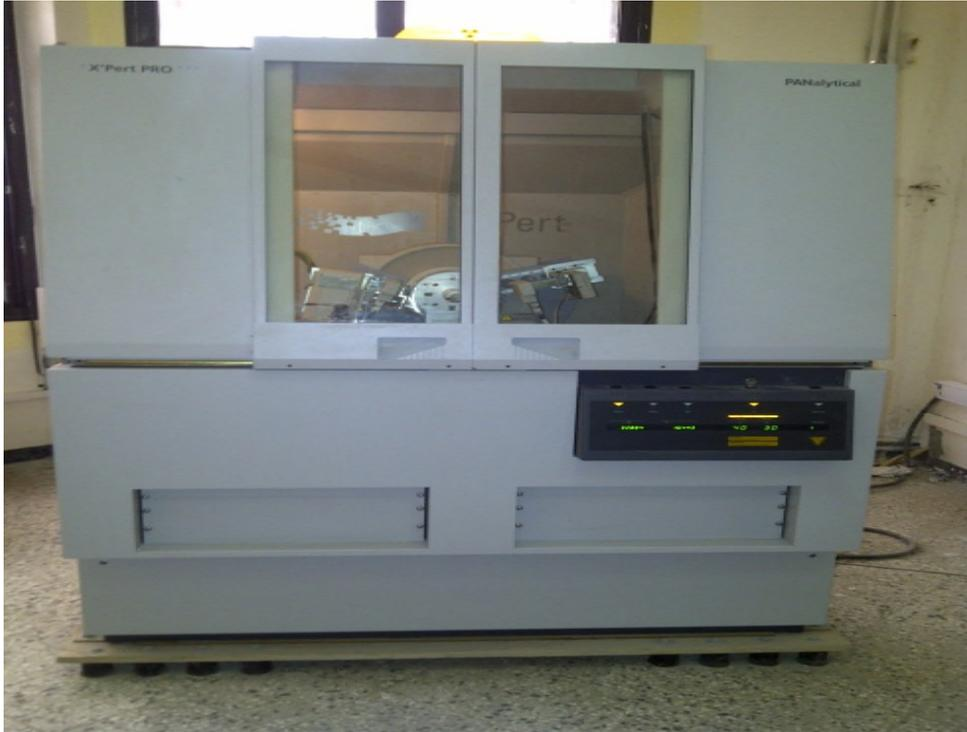
**Figure 10.** Diffractomètre utilisé pour la diffraction des rayons X.
