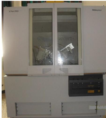
FIGURE 4.10 – Diffractomètre à rayons X (PANalytical)
