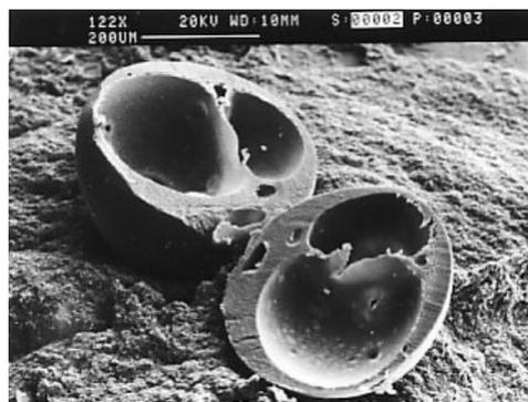
FIGURE 2.2 – Vue au SEM d'une microcapsule coupée en deux
