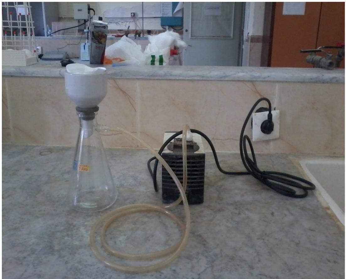
**Figure 17 : Montage de Buchner utilisé pour la filtration.**
