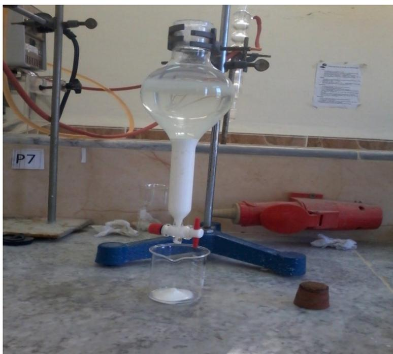
**Figure 10 : ampoule à décanter.**
