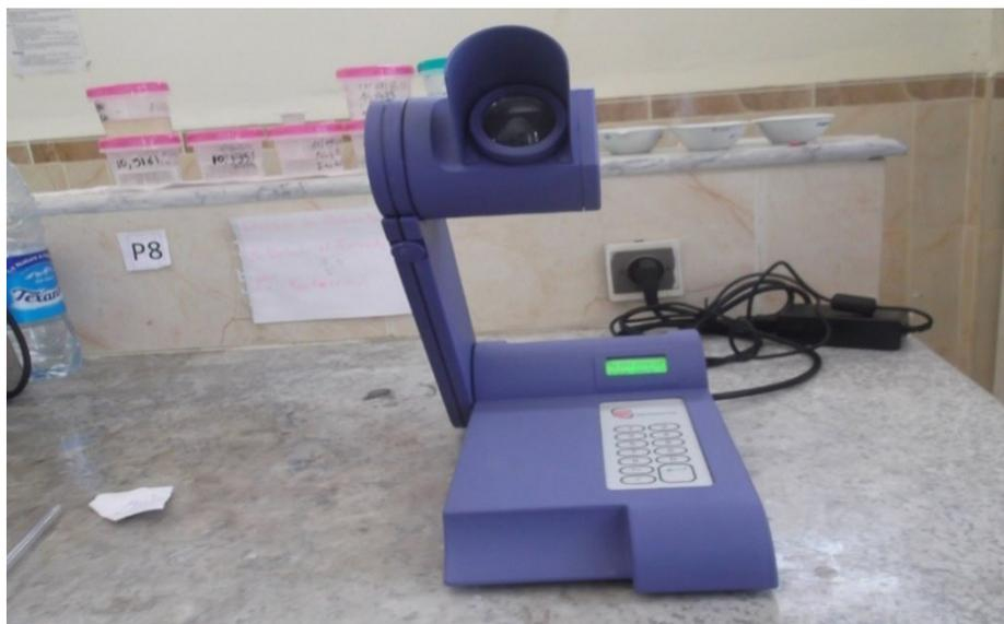
Figure 22: fusionimètre utilisé lors des manipulations
