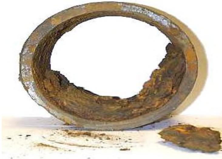
**Figure 3.** La corrosion des tuyauteries.
