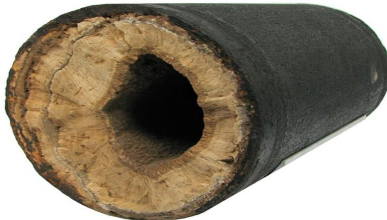
**Figure 2.** Phénomène d'entartrage sur les canalisations.
