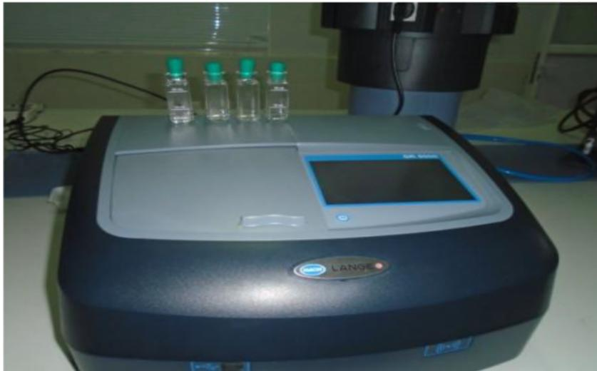
**Figure 9.** Spectromètre UV-VIS (DR 6000).
