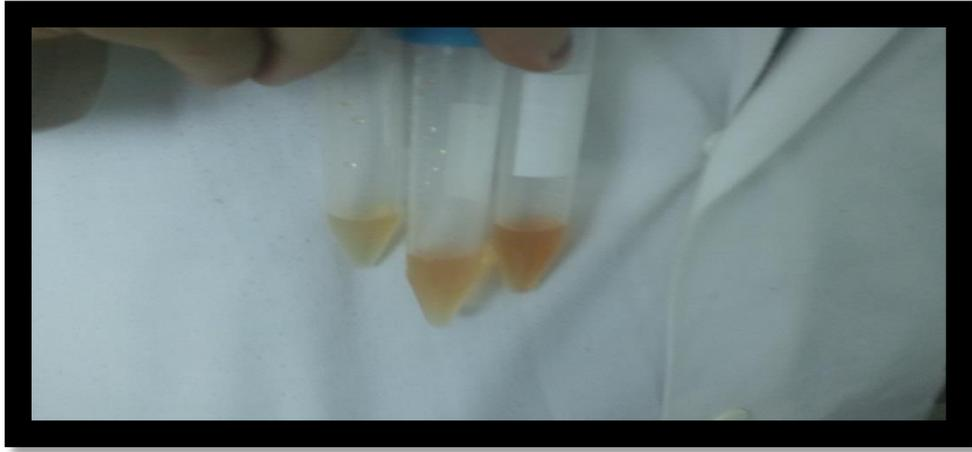
**Figure21** : les échantillons après ajout de réactif de nessler.
