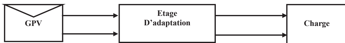
Figure III.2 : Etage d'adaptation jouant le rôle d'interface de puissance entre un GPV et une charge pour le transfert de P_{MAX} du GPV.
