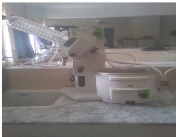
**Figure 16 :** Montage de la méthode d'évaporation de solvant sous vide (rotavapeur).
