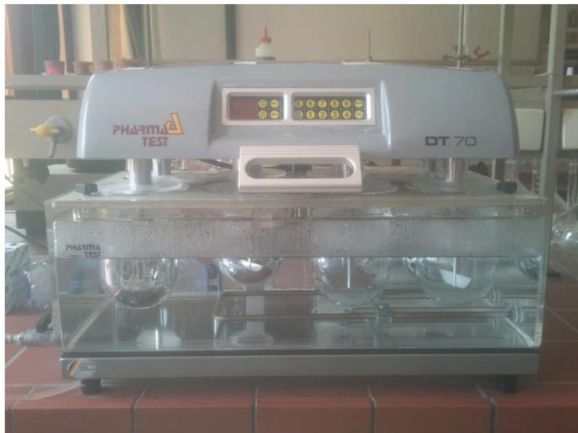
**Figure 18 :** Montage de dissolu test.
