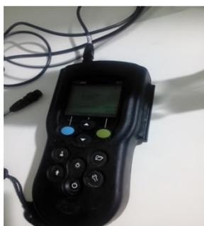
**Figure 7:** Représentation du conductimètre utilisé.
