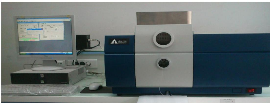
**Figure I.6 :** Spectrophotomètre à absorption atomique utilisée au niveau du laboratoire de LTMGP de Bejaia.
