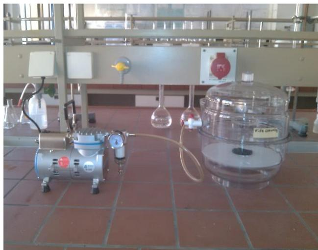
Figure 12 Becher contenant les particules de suies dans un dessiccateur sous vide
