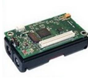
FIGURE 1.1 – Nœud capteur.
