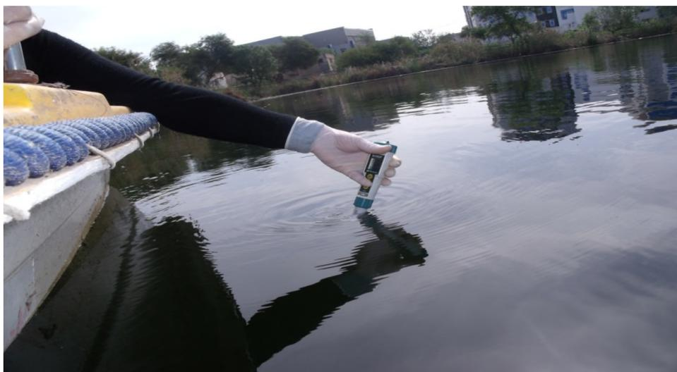
**Fig.11 :** Mesures du pH et de la température de l'eau in situ à l'aide d'un multi paramètre de marque Exttech.
