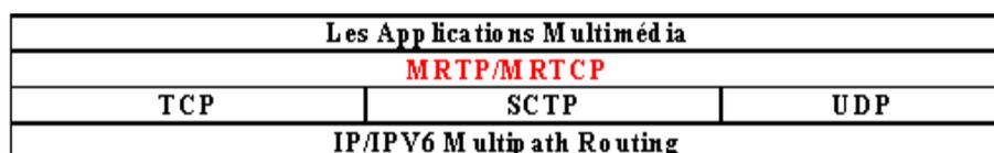
Figure 4.2 : Position du protocole MRTP/MRTCP dans la pile TCP/IP[55]
