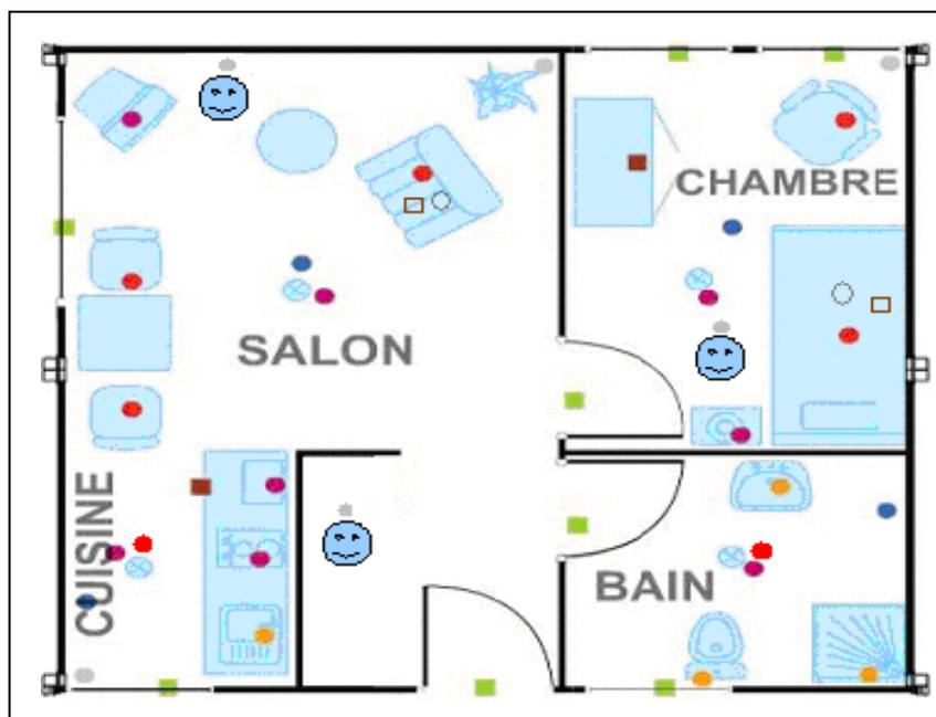
Fig. VII.1 : Système de capteur du domicile de la personne dépendante
