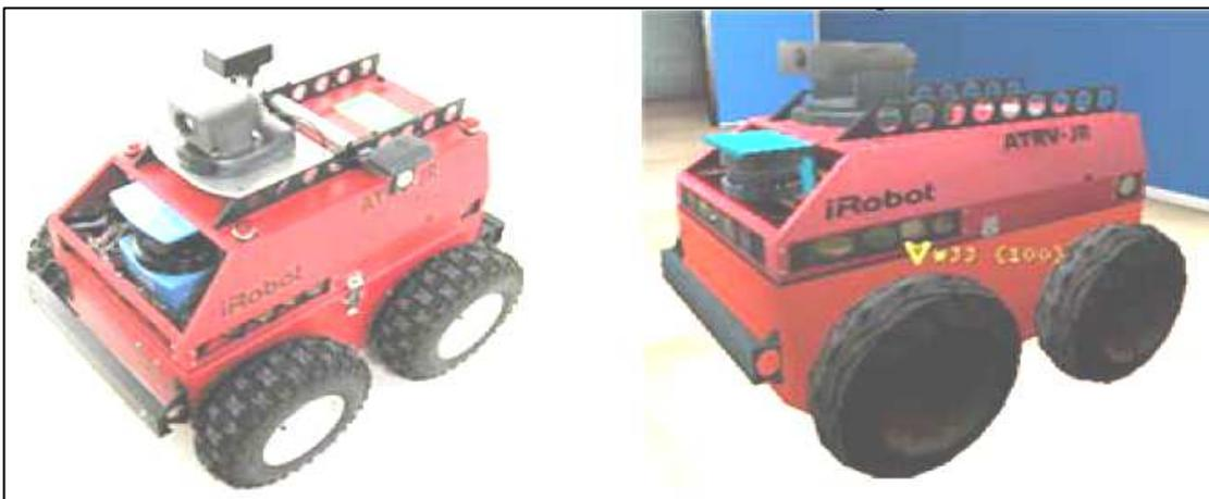
Figure 5.4: Robot ATRV-Jr (réel / simulé)
