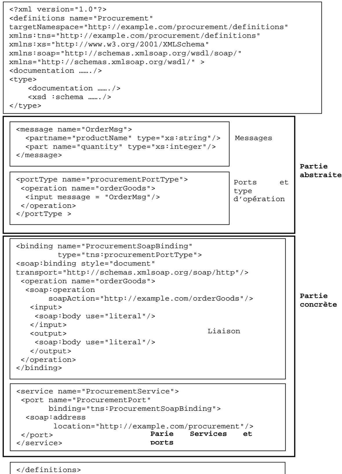
Figure 18. Le schéma XML d'un document WSDL.
