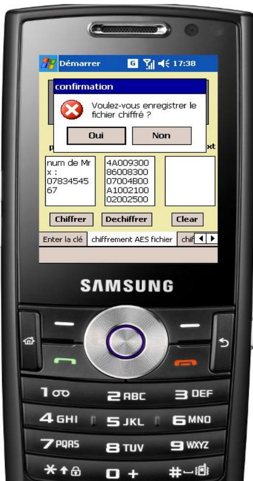
**Figure 4.18.** Fonction de chiffrement d'un numéro de téléphone sélectionné sur l'émulateur du téléphone
