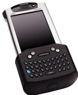
**Figure 2.3.** *Mini Clavier pour PDA Ipaq de Compaq*
