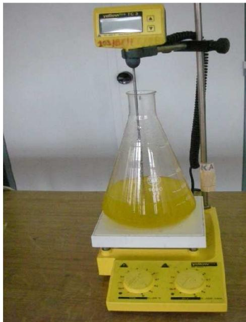
**Figure II.4 :** Dispositif expérimental utilisé pour les tests d'adsorption.
