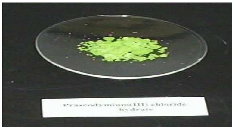
**Figure 18** : Le trichlorure de praséodyme  $\text{PrCl}_3$ .
