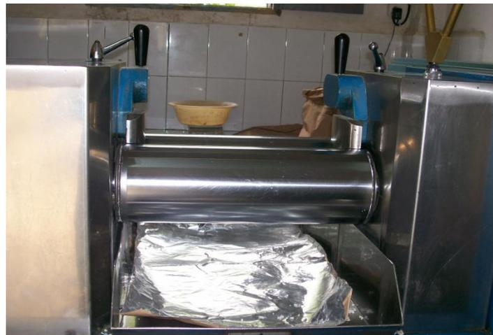
**figure.7 : Mélangeur à deux cylindres**
