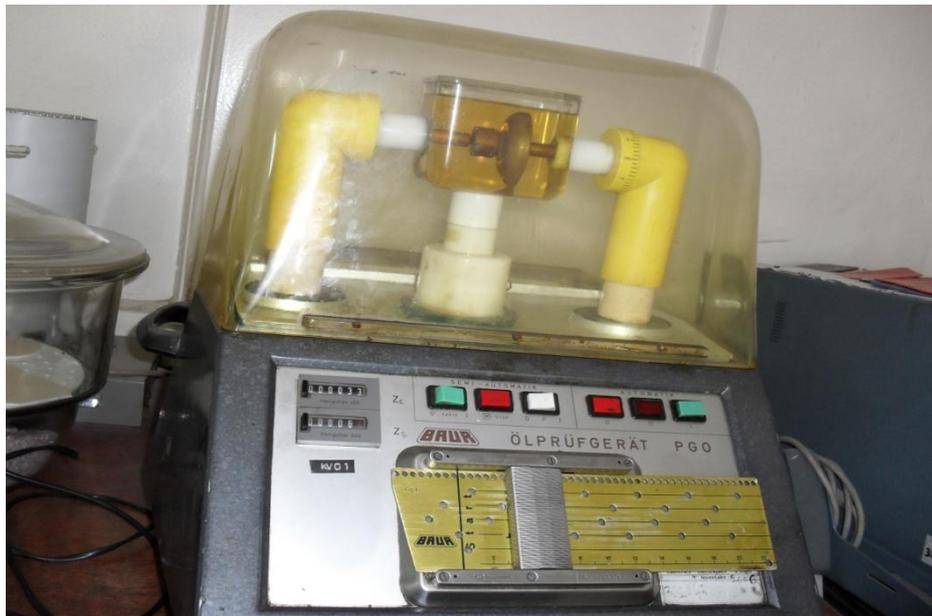
Figure. 12 : Appareil de mesure de la tension de claquage.
