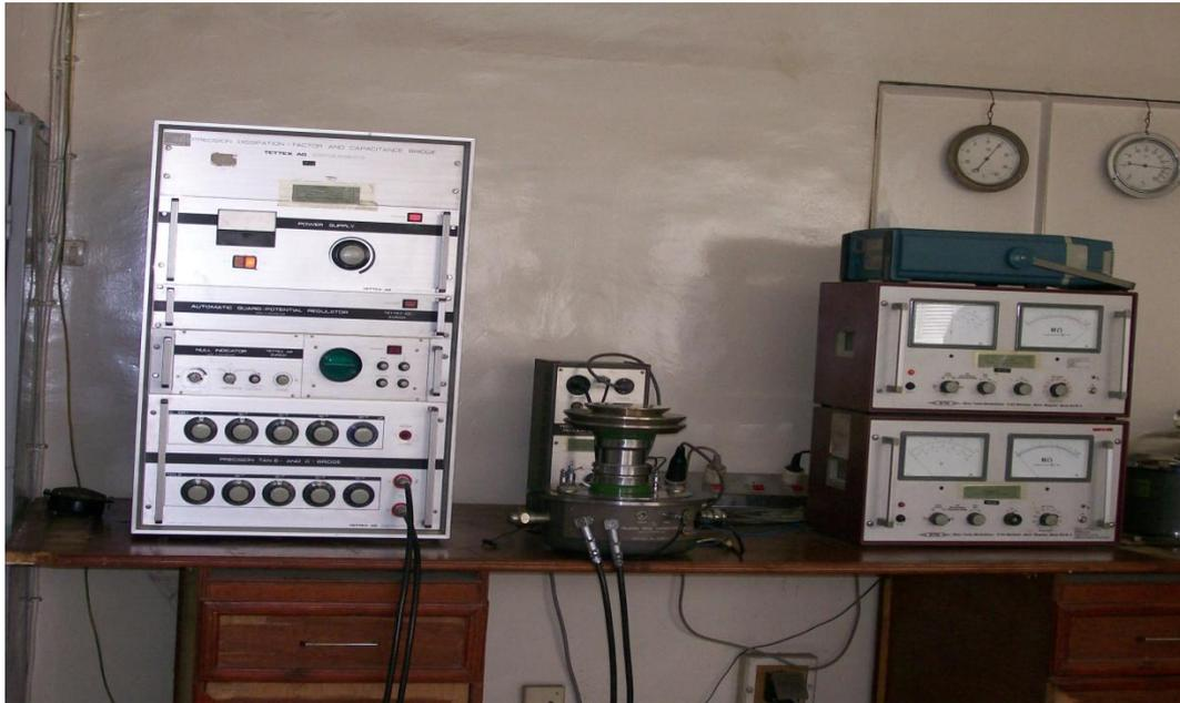
**Figure. 11 : Appareil de mesure de la permittivité.**
