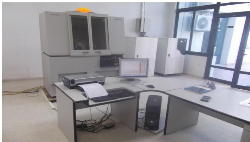
**Figure II.5.** *Diffractomètre des rayons X de type Panalytical Pro Data Collector*
