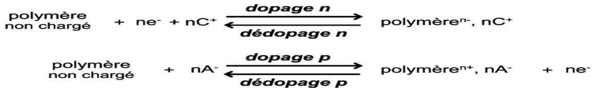
**Figure I.9.** Principe des dopages/dédopages positif et négatif des polymères conducteurs
