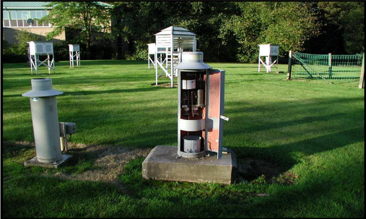
Fig. I.4. Le pluviographe à siphon (le dispositif ouvert)
