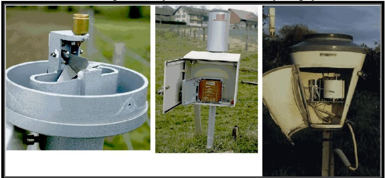
Fig. I.3. Pluviographes à auges basculeurs
