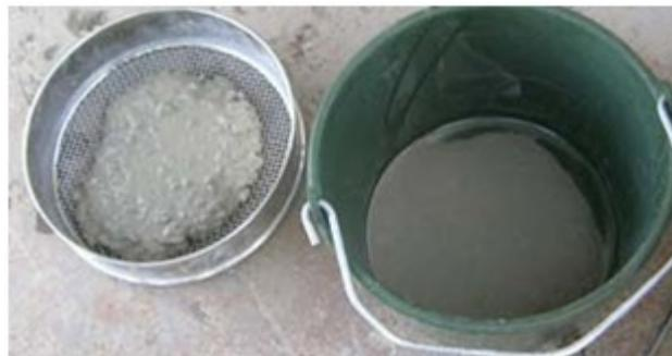
Fig. 29 : Essais de ségrégation au tamis.
