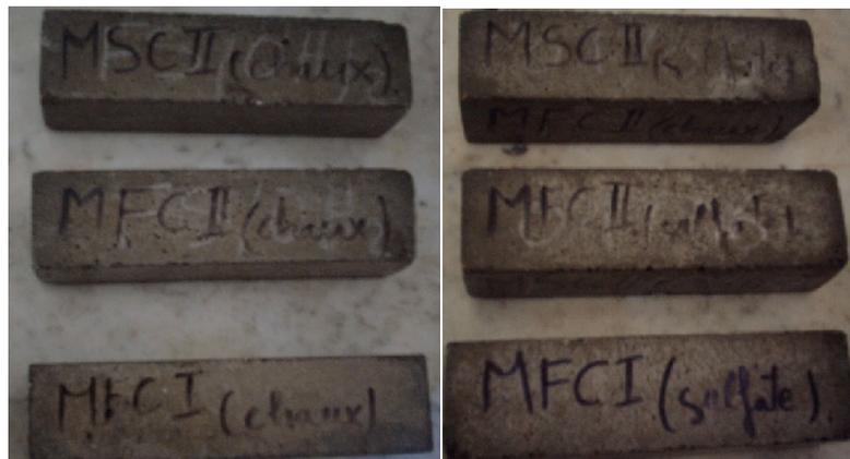
Fig. 36: Mortiers conservés dans les solutions d'essai pendant 90 jours.
