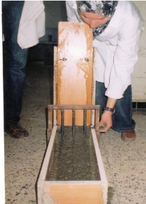
Fig. 28 : Essai de la boîte en « L ».
