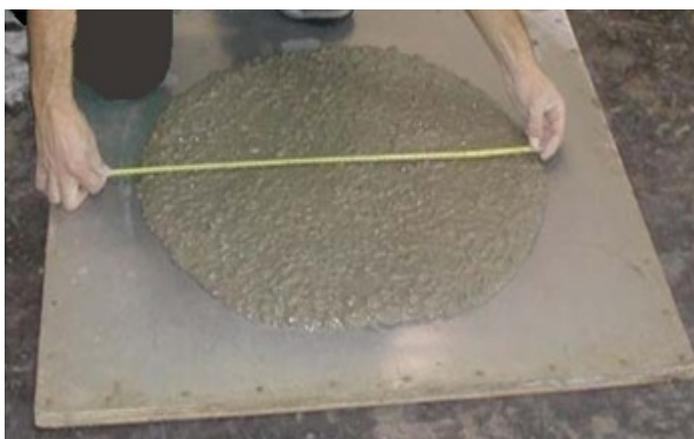
Fig. 27 : Essai d'étalement des bétons autoplaçants.
