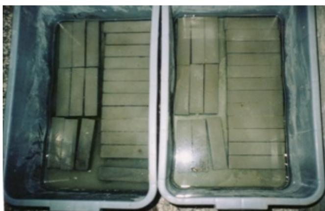
Fig. 32 : Immersion des mortiers dans les solutions d'essais.
