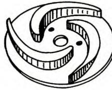
*Figure V.6. Roue semi ouverte*
