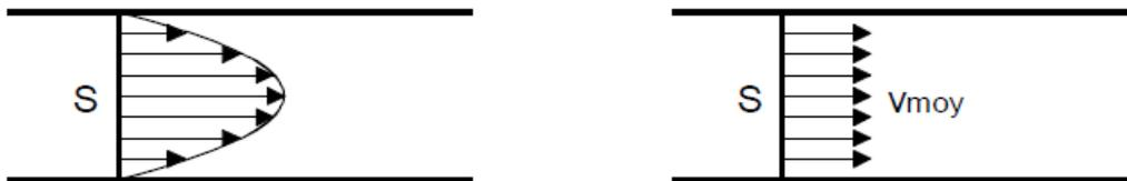
**Fig.II.4 :** Écoulement en eau peu profonde – Distribution de la vitesse-
