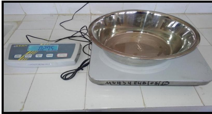
*Figure (II.4) : Balance électrique pour peser le tamisât de chaque tamis*
