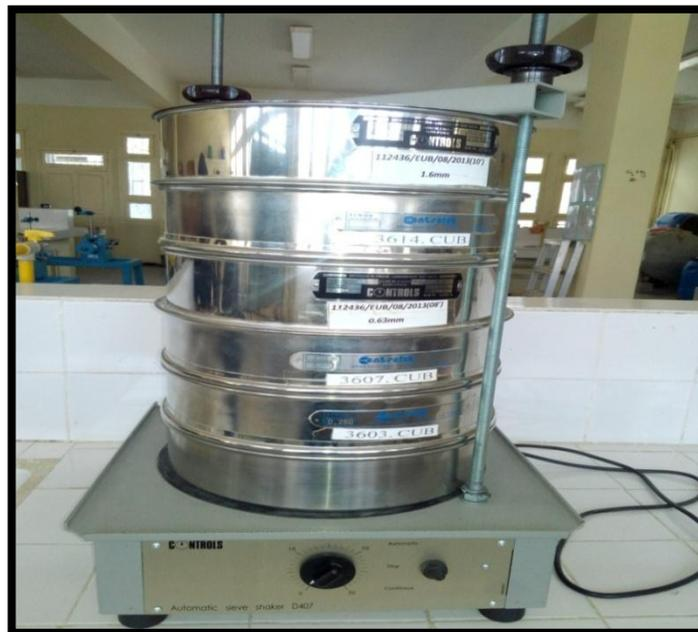
*Figure (II.3) : Agitateur utilisé pour l'analyse granulométrique*
