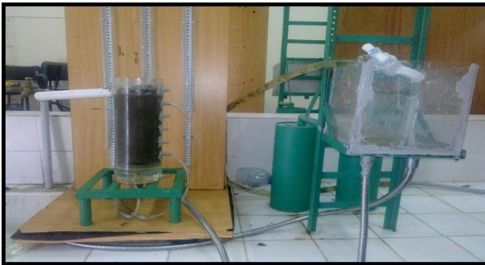
*Figure (II.8) : Appareil d'expérience de la conductivité*
