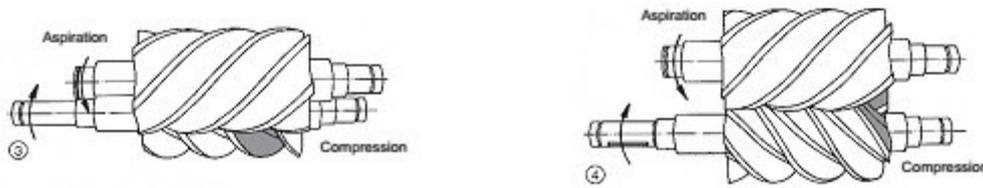
**Figure I-3** Compression sur un compresseur à vis
