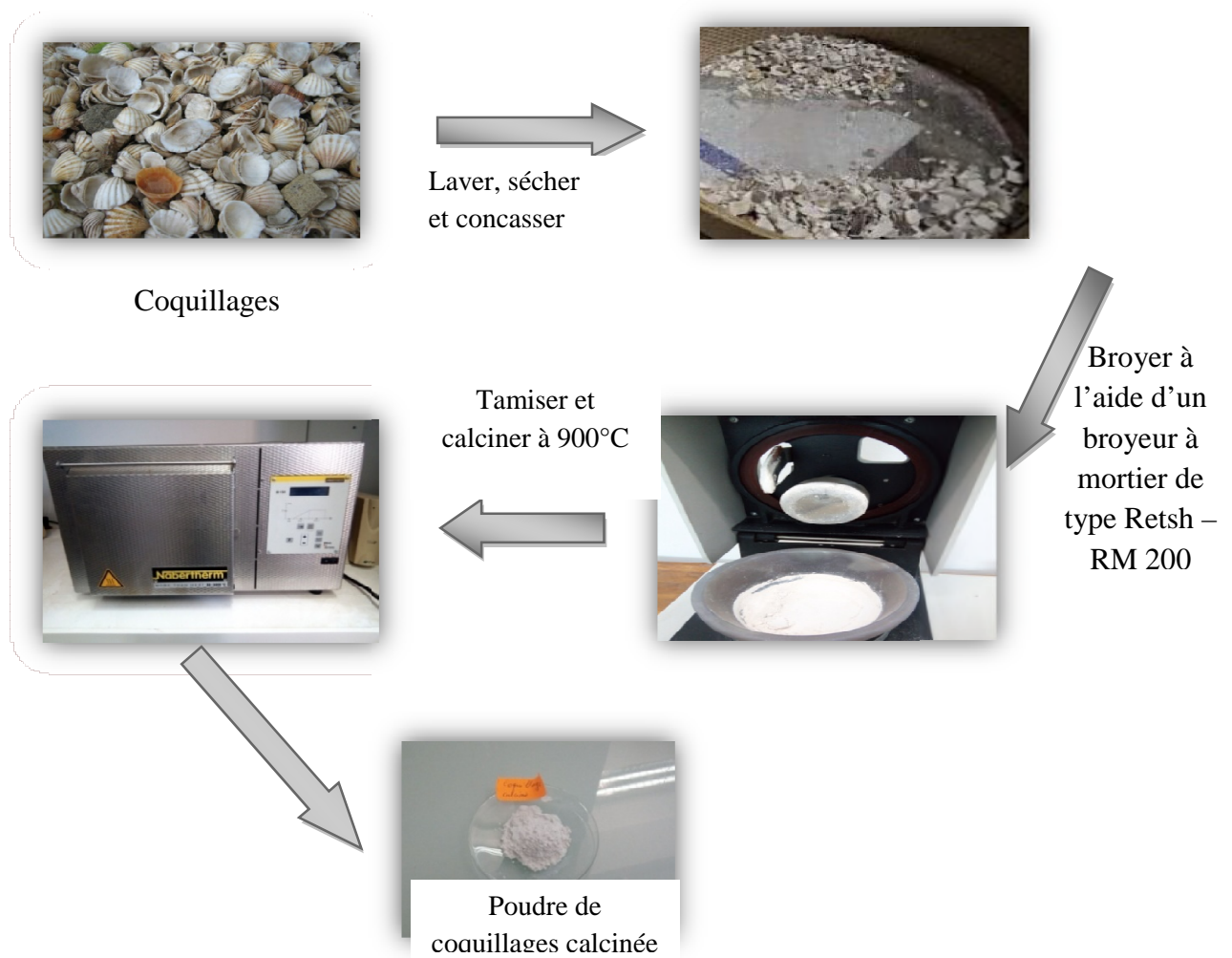
Figure III.2 : Schéma résumant les différentes étapes de préparation de la poudre des coquillages calcinés.
