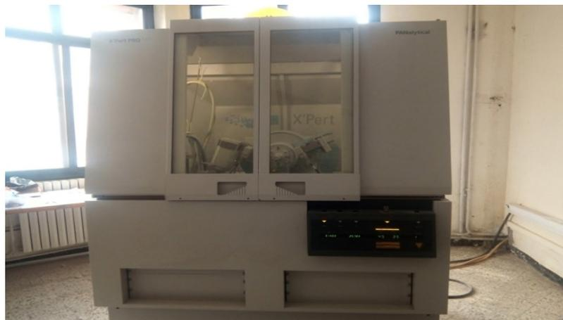
**Figure I.13 :** Photographie du diffractomètre X Pert PRO (Université A MIRA.BEJAIA)
