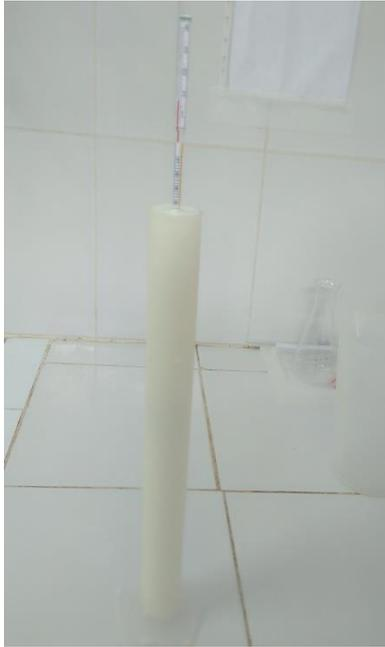
**Figure II.5** : mesures de la masse volumique du lait
