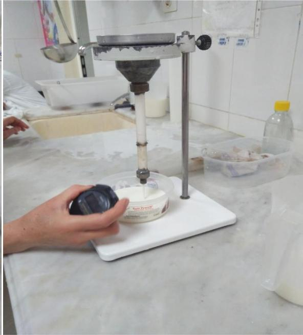
**Figure III. 4 :** mesure de la viscosité du mix
