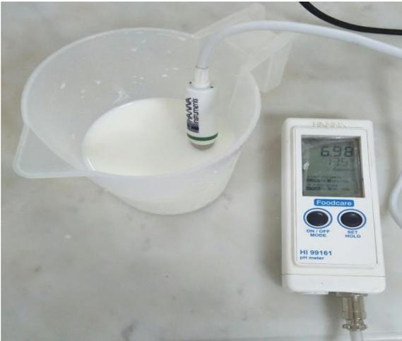
**Figure II.1 :** mesure de pH du lait
