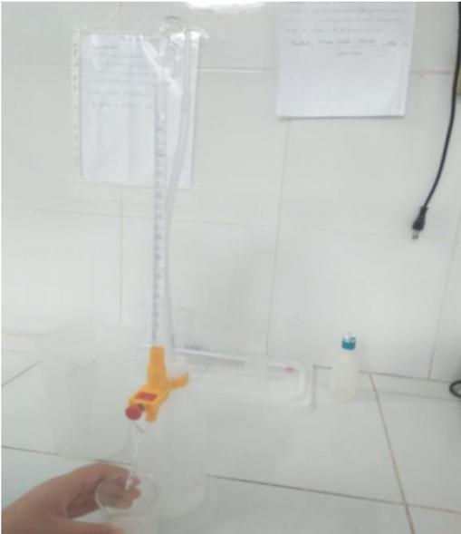
**Figure II.3 :** mesures d'acidité titrable du lait
