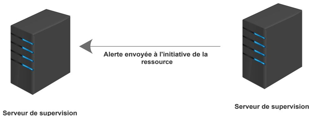
FIGURE 2.6 – Échange de messages dans une supervision passive.
