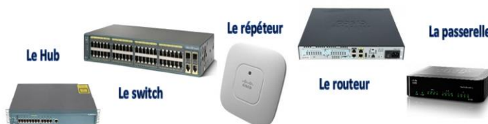
Figure 4 : Les équipements d'interconnexion.
