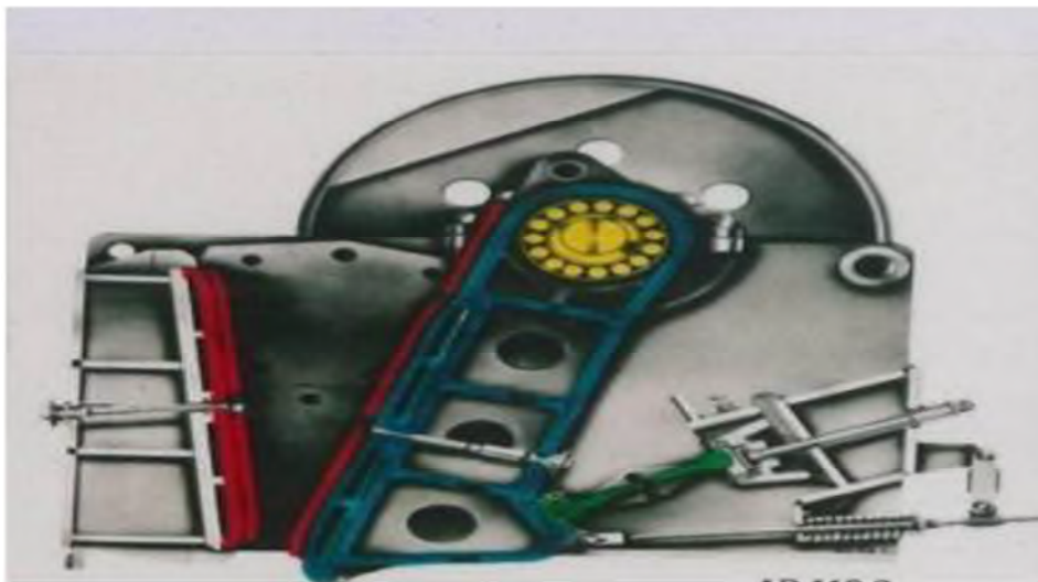
FigureII.2 : Concasseur à mâchoire à simple effet [15].
