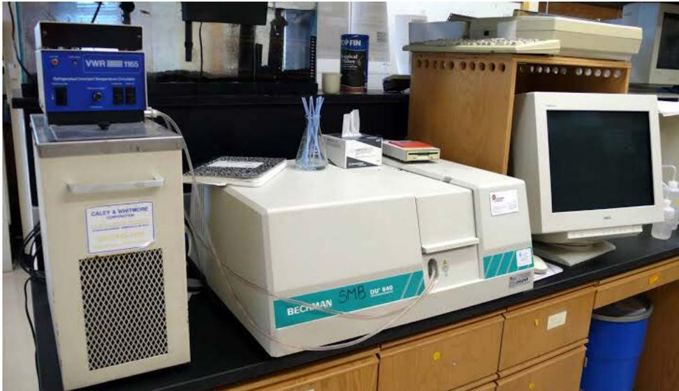
**Figure II.11:** appareillage de la spectrométrie UV-visible.
