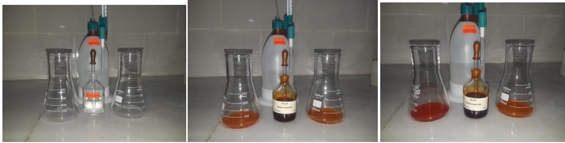
Figure 18: Réactifs et les procédure de titrage TAC
