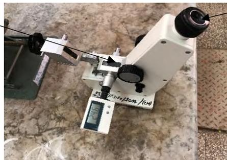
**Image II.4** : réfractomètre à température ambiante
