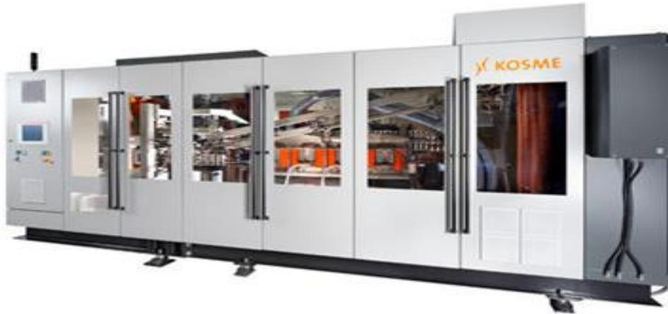
**Figure II.2 :** Souffleuse de fabrication de bouteilles PET
