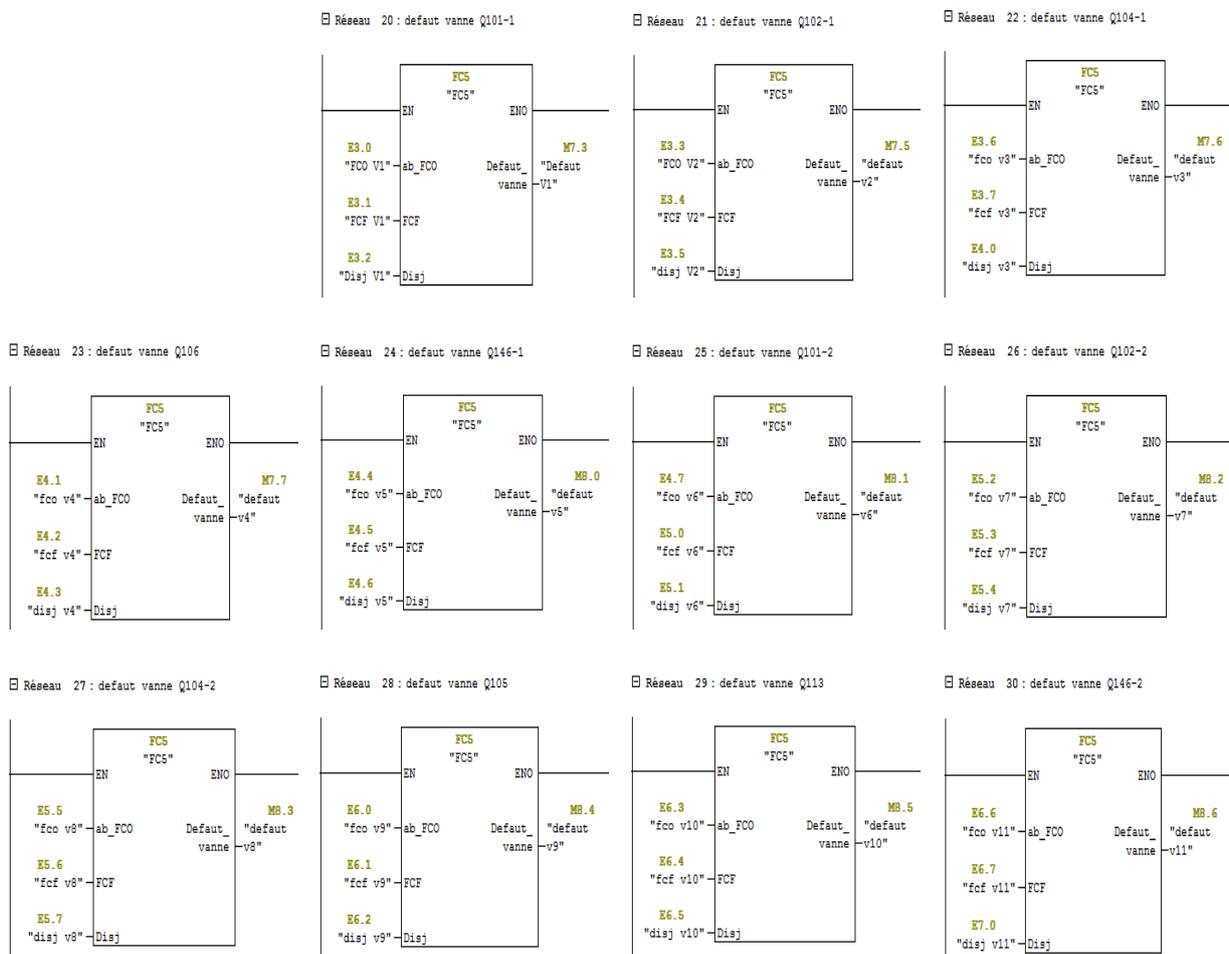
Figure IV.4 : Commande de défauts de vannes
