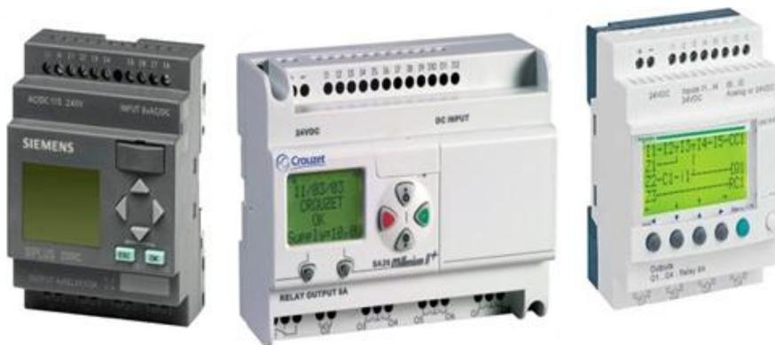
Figure (I.3) :Automates compacts: SIEMENS, CROUZET et ZELIO
