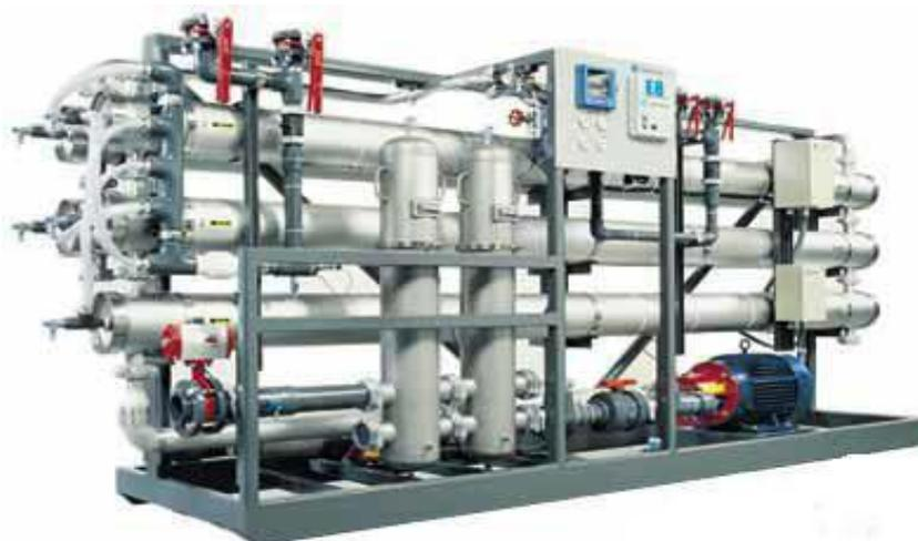
**Figure II.3 :** Exemple d'un osmoseur industriel
