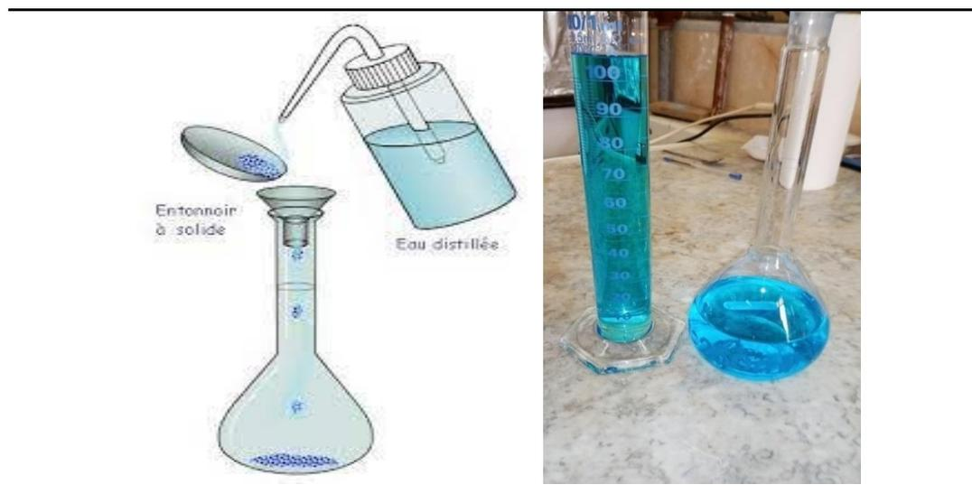
**Figure 14:** Préparation de la solution mère Bleu de méthylène.
