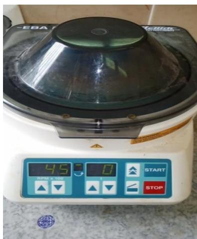
**Figure4** : Centrifugeuse.
