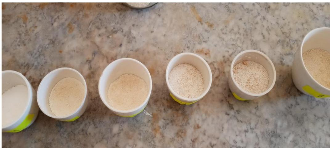
**Figure 13 :** Aspect des catalyseurs après calcination pendant 1heure à T=850 C°.
