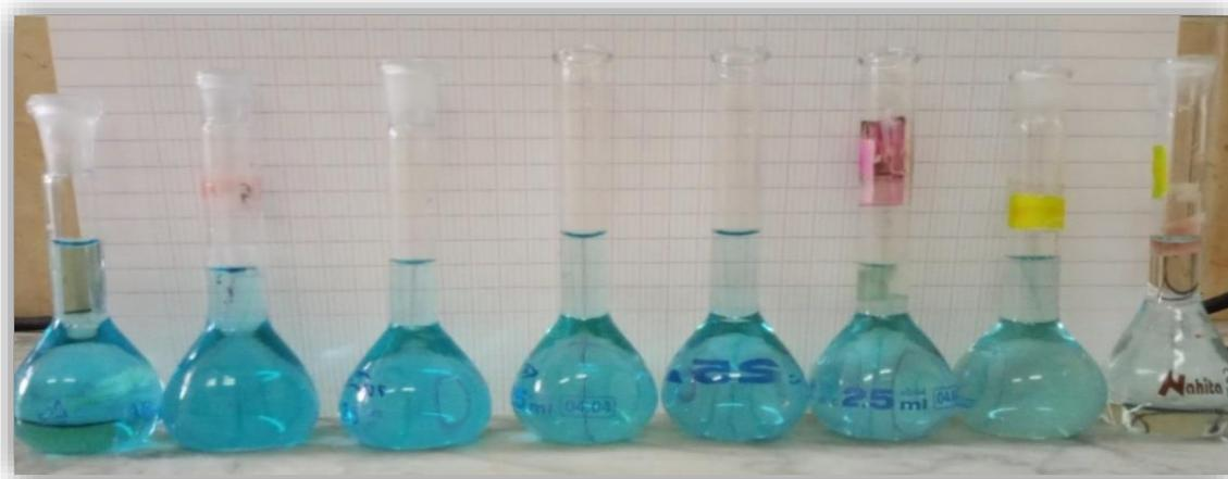
**Figure 16 :** une série de solutions filles à différentes concentrations (0.5 à 3 mg/L).
