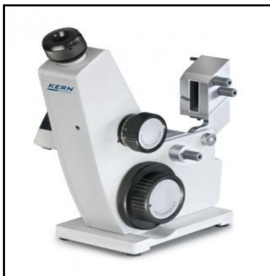
Figure II.6: Mesure de l'indice de refraction avec réfractomètre d'Abbé.
