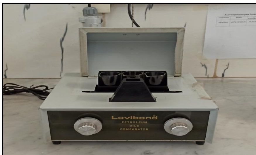
Figure II.7: Mesure de la couleur avec le colorimètre.
