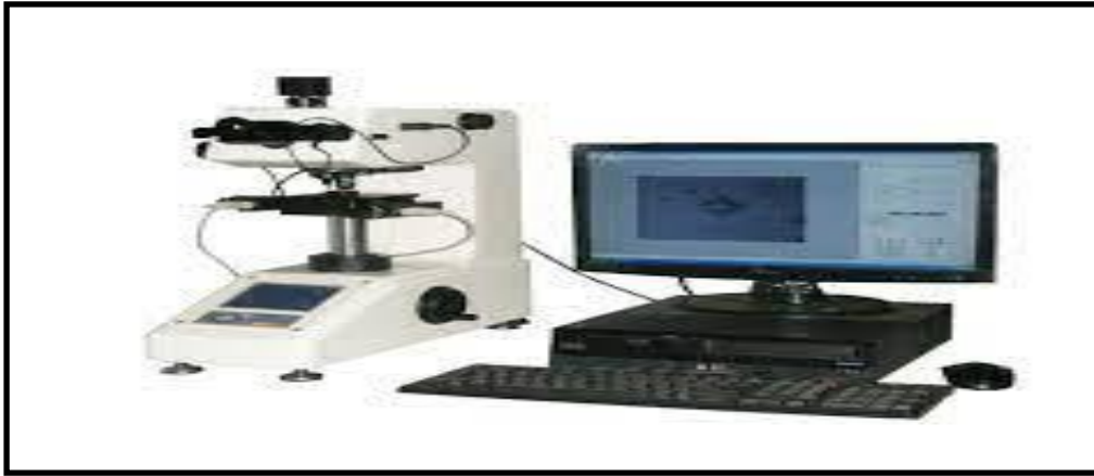
Figure I.8 : la mesure de dureté HV [10].
