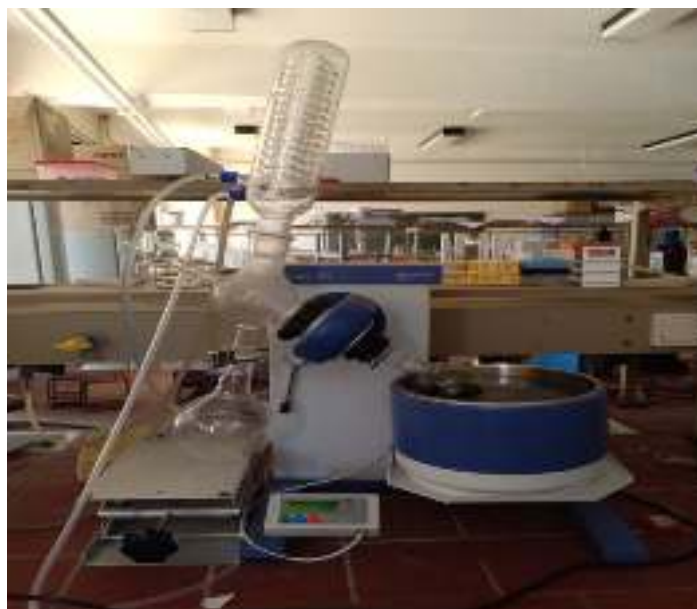
Figure 10 : Evaporation d'un extrait phénolique avec l'évaporateur rotatif ( BOECO, Germany ).
